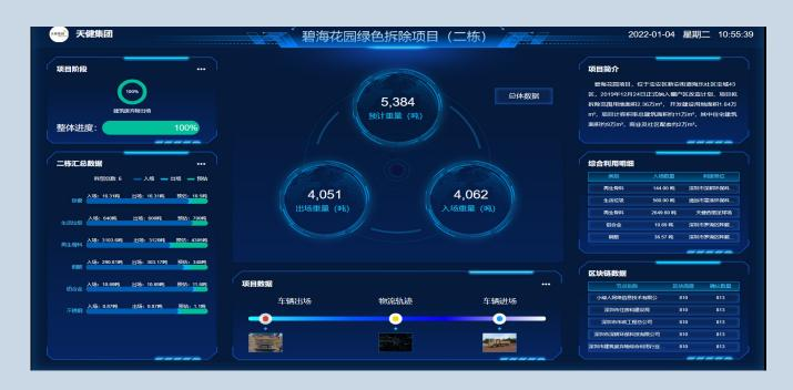
特区建工集团核心企业天健集团承接的宝安碧海花园棚户区改造项目,作为深圳市首批绿色建造试点项目,积极探索建筑废弃物综合处理与利用技术,构建起了区块链建废跟踪系统,对项目拆除的全过程数据实时跟踪,提高固废监管效率。
